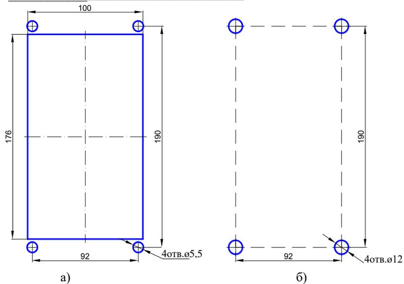
Рис1. Разметка под крепление DPU5000-KEDC T/IP-CVBS
